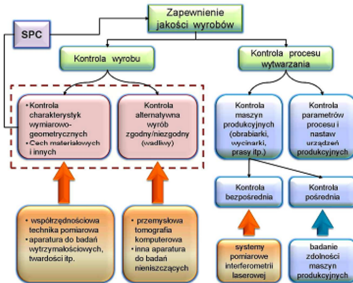
Rysunek 14. Ogólna struktura systemu zapewnienia jakości wyrobów w przemyśle maszynowym (J. Gawlik, J. Śladek, A. Ryniewicz, M. Kowalski, A. Gąska, Wielofunkcyjna ocena jakości urządzeń technologicznych i wyrobów , Inżynieria Maszyn , R. 15, z. 3, 2010)
