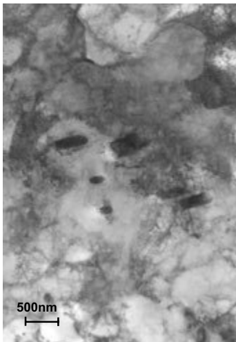
Rysunek 81. Struktura ferrytyczno-bainityczna stali 10CrMo9-10 w stanie wyjściowym: a) obserwowana w SEM, b) obserwowana w TEM; skład fazowy wydzieliń: M_3C + M_2C + M_{23}C_6
