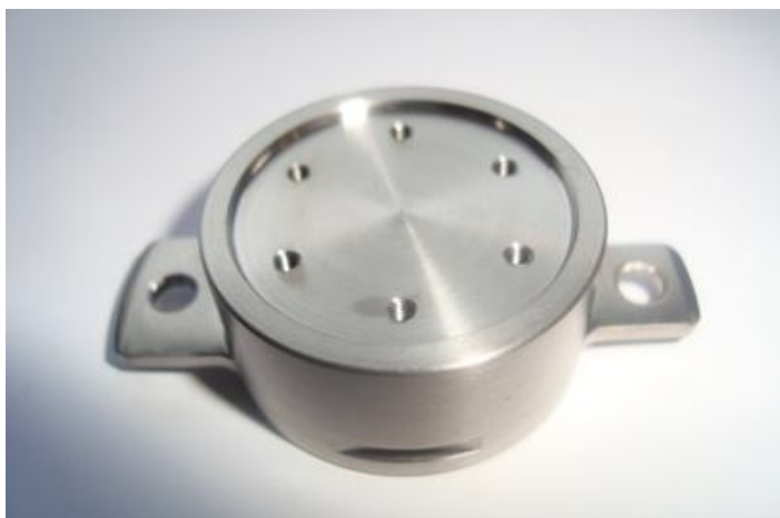
Rysunek 3.10. Wygląd standardowego nośnika próbek do badań przy użyciu spektrometru fotoelektronów firmy Physical Electronics PHI 5700/660
