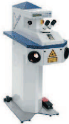
Rysunek 4.1. Laserowa spawarka ALPHALASER Laser ALC 35 wyposażona w mikroskop. Aparat o wszechstronnym zastosowaniu nadający się do laboratoriów o niewielkiej powierzchni [51]
