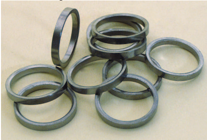
Rysunek 13. Przykłady części z proszków spiekanych wykonywanych w jednej operacji kształtowania [23, 24] [badania własne]
