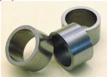
Rysunek 14. Przykłady części z proszków spiekanych wykonywanych w dwóch operacjach kształtowania plastycznego [badania własne]
