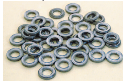
Rysunek 14. Przykłady części z proszków spiekanych wykonywanych w dwóch operacjach kształtowania plastycznego [badania własne]
