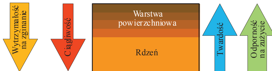
Rysunek 3.1. Schemat ideowy gradientowego materiału narzędziowego (TGM)
