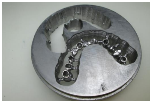
Rysunek 9.15. Podbudowa mostu okrężnego ze stopu Co-Cr zaraz po wyfrezowaniu z użyciem frezarki numerycznej CNC – widok w krążku materiału
