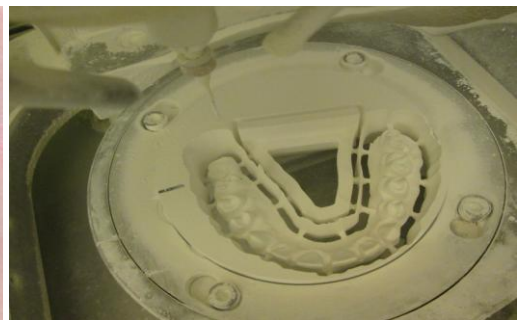
Rysunek 9.10. Most okrężny w trakcie frezowania we frezarce numerycznej CNC
