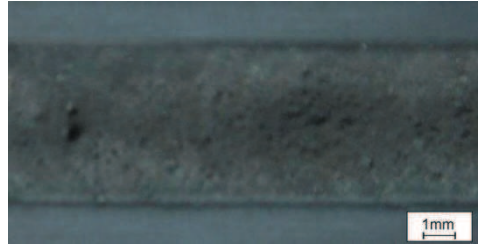
Rysunek 6.2.8. Widok lica przetopienia warstwy wierzchniej odlewniczego stopu magnezu MCMgAl12Zn1 po wtapieniu proszku VC; moc lasera 1,6 kW, prędkość wtapienia 0,75 m/min
