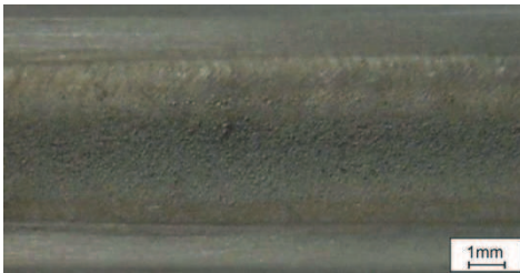
Rysunek 6.2.5. Widok lica przetopienia warstwy wierzchniej odlewniczego stopu magnezu MCMgAl3Zn1 po wtopianiu proszku WC; moc lasera 1,6 kW, prędkość wtopiania 0,75 m/min
