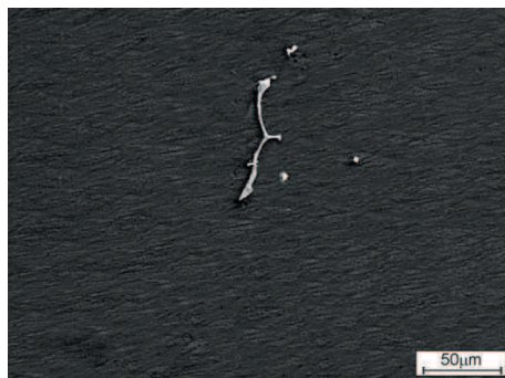
Rysunek 4.2.6. Struktura odlewniczego stopu magnezu MCMgAl3Zn1 w stanie przesyconym po ochłodzeniu w powietrzu
