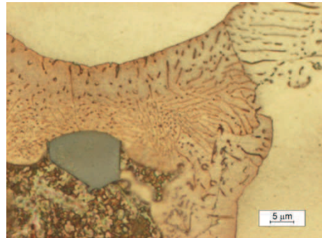
Rysunek 25. Mikrostruktura odlewniczego stopu magnezu MCMgAl9Zn1 w stanie lanym
