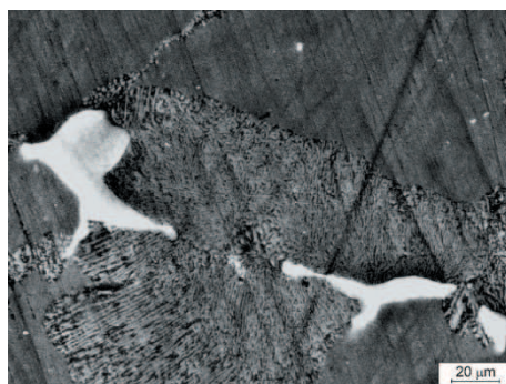
Rysunek 31. Struktura odlewniczego stopu magnezu MCMgAl9Zn1 w stanie po starzeniu
