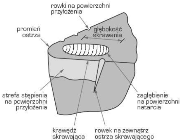
Rysunek 233. Schemat typowego zużycia noża tokarskiego
