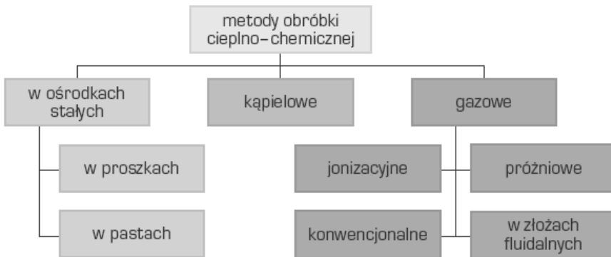
Rysunek 22. Podział metod obróbki cieplno-chemicznej ze względu na stan ośrodka nasycającego
